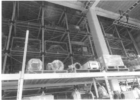
広大な立体自動倉庫。ピットには船名毎に必要な 治具や部品等が収められ、即座に入出庫が可能。
